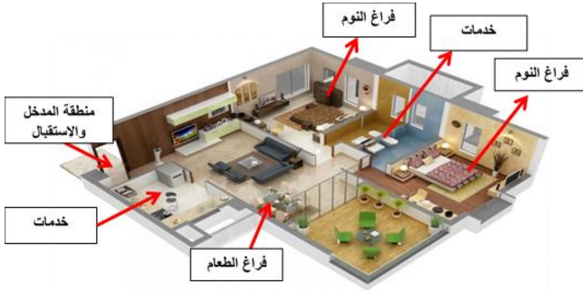
شكل (9) شقة سكنية ثلاثية الأبعاد موضح عليها الفراغات الداخلية لها بالتسلسل وفقاً لدرجة الخصوصية طبقاً للأنشطة التي تقام بها. (32)
