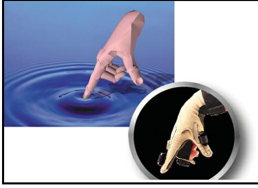
الشكل (4) جهاز اللمس الذي يضع المحركات تهتز على أطراف الأصابع وكف اليد.
