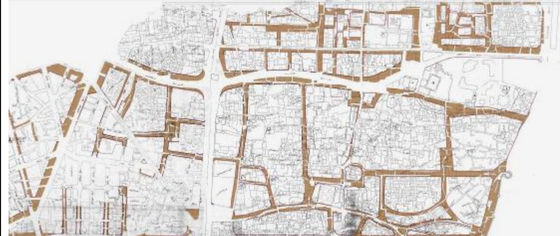
شكل " ١٠ " لأجزاء المحذوفة من النسيج العمراني اثر تطبيق خط التنظيم المعتمد والتي تقدر بـ ٤.٢% تقريبا
