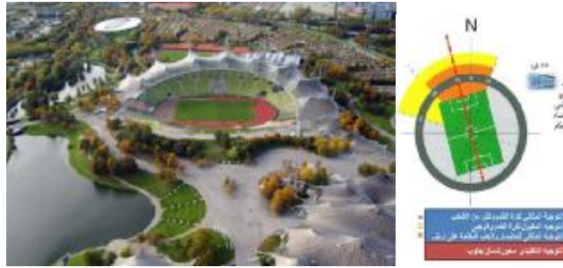
شكل (١) أسكتش يوضح التوجيه المناسب شكل (٢) الاستاد الأوليمبي بميونخ نموذج للتصميم السالب المصدر: www.maber.co.uk المصدر: www.archdaily.com
