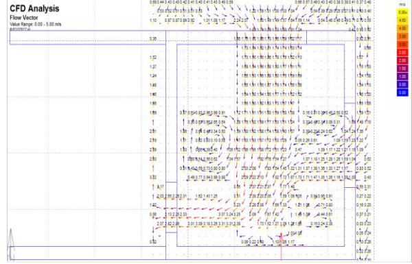
شكل (٩) محاكاة لحركة الهواء داخل الغرفة الأولى موضحة بأسهم توضح اتجاه حركة الهواء ومسارها وتوزيعها داخل الغرفة
