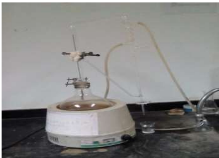
شكل (٢) جهاز التقطير ببخار الماء (كليفنجر)
