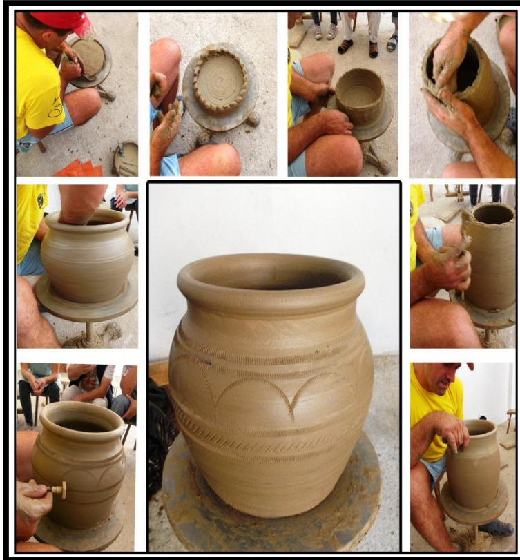
شكل رقم (٧) خطوات طريقة البرم (زلاكوسا) في تشكيل الأشكال الخزفية
