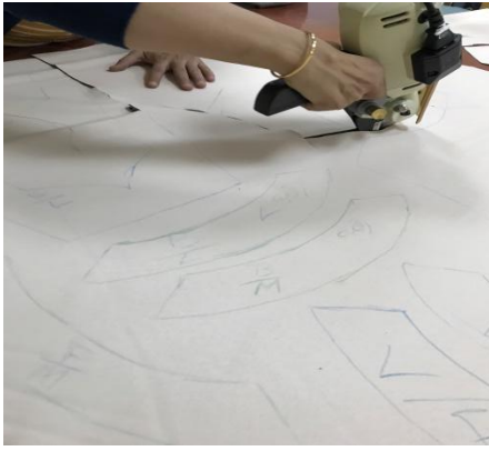
صورة (٤) توضح مرحلة القص بالمقص الكهربائي المستدير
