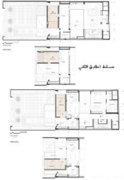
شكل ١٠، ١١: يوضح المساقط الأفقية من الدور الثاني حتى الثالث قبل و بعد دوران جزء من كتلة واجهة المبنى
