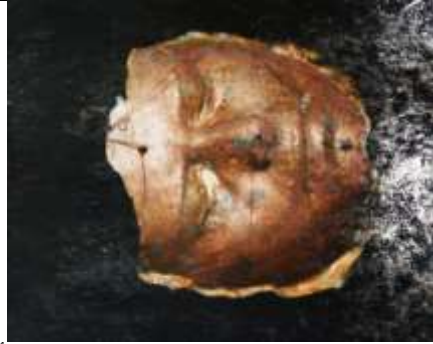
شكل ( ٣٨ ) ترسيب طبقة من النحاس الأحمر على قالب ليورتريه من الجبس.
