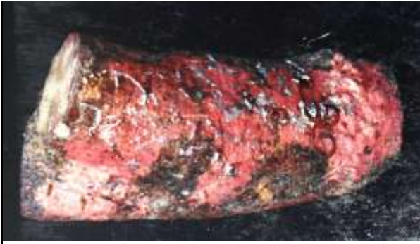
شكل ( ٥٤ ) قطعة من ساق تم ترسيب عليها طبقة من النحاس الأحمر ثم صهر القصدير على السطح وأيضاً لحام شريحتين بالقصدير
