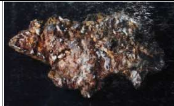
شكل ( ٥٧ ) قطعة من الحجر تم ترسيب عليها نحاس أحمر تم ترسيب طبقة من النيكل على بعض أجزاء منه ثم صهر القصدير عليها.
