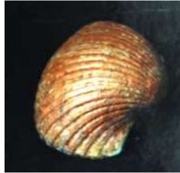
شكل ( ٤٥ ) ترسيب طبقة من النحاس الأحمر على قطعة قوقعة بحرية
