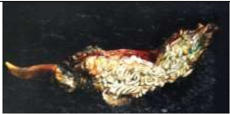
شكل ( ٥٢ ) ترسيب طبقة من النيكل على قطعة مشكلة بالبلاستيك
