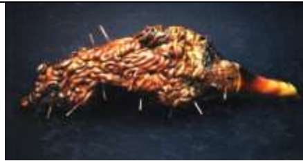
شكل ( ٤٢ ) ترسيب طبقة من النحاس الأحمر على قطعة مشكلة من البلاستيك
