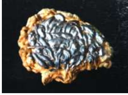
شكل ( ٤٦ ) ترسيب طبقة من النيكل على قطعة مشكلة بالبلاستيك
