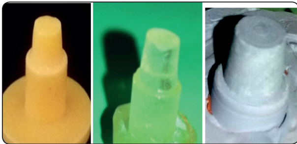
Fig. (1) A,B,C A) 3D printing die B) epoxy die C) stone die
