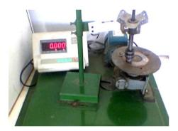
Fig. 1 Pin-on-Disk test rig.
