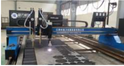
شكل (3، 4): ماكينات القطع بقوس البلازما ذات التحكم الآلي المصدر: www.en.wikipedia.org.plasama-cutting
