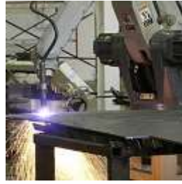
شكل (3، 4): ماكينات القطع بقوس البلازما ذات التحكم الآلي المصدر: www.en.wikipedia.org.plasama-cutting
