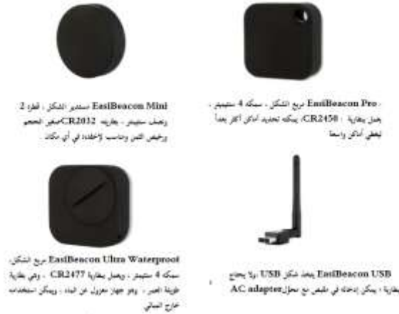
شكل رقم (١٥) النماذج المختلفة من جهاز المرشد اللاسلكي
