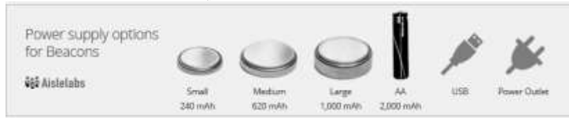
شكل رقم (٧) وسائل تزويد المرشد اللاسلكي بالطاقة
