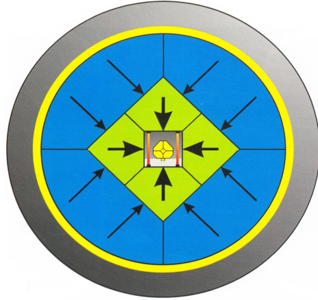
شكل 3: يوضح نظام BARS لإنتاج الماس الصناعي
