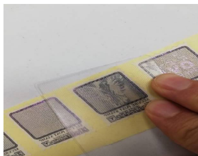
شكل (3) استخدام الشريحة الفيلمية لإظهار الصورة الخفية من خلال تثبيتها على زاوية محددة
