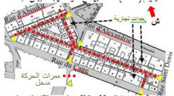
شكل رقم (15) لمسقط الأفقي لممر القاهرة بباريس Passage du caire من النماذج الأولى للاركيد، افتتح عام 1799م، وهو عبارة عن صورة مصغرة للشوارع التجارية لكنه مغطى ليتحكم في التهينة المناخية (30) .
