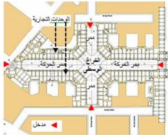
شكل رقم (16) مسقط ممر بفيكتوريو إمانويل Vittorio Emanuele II بروما، يربط بين ميدان بيازار دومو Piazza Duomo وساحة ديلا سكاللا Della Scala ، يحوي على فراغ وسطي، يربط بين ممرين متعامدين ليزيد من عدد المتاجر، ليتناسب مع معدل الاحتياج دون زياده طول الممر (31) .
