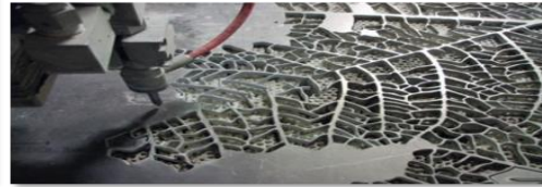
(أ) تقنية القطع باندفاع ضغط الماء water-jet (ب) تقنية القطع بإستخدام أشعة الليزر LASER beam
