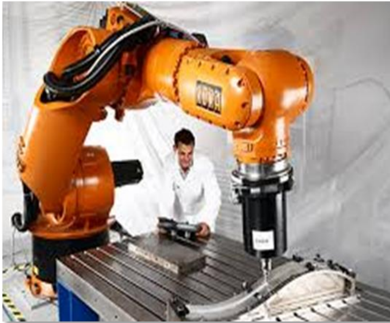
شكل (٥) - يوضح الروبوت ذو محاور القطع ال٧ axes milling robot والذي يقوم بالثني وعمليات الدهان بالرش بالإضافة لقطع عالي الدقة. /https://www.kuka.com
