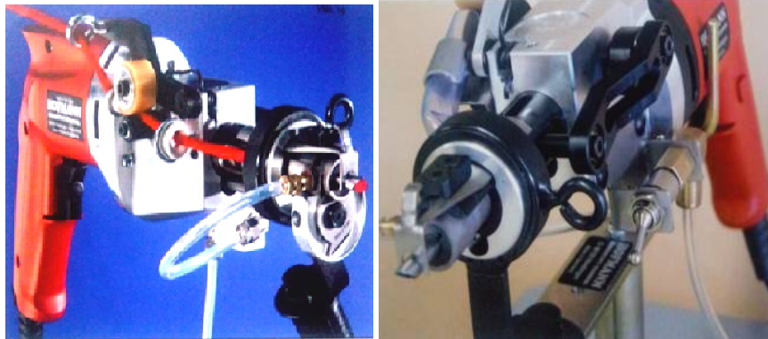
شكل (2) المسدس الذي يقوم بغرز الخيوط الخاصة بالوبرة داخل نسج الأرضية
