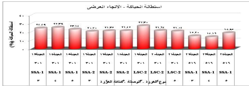
شكل (8): يوضح تأثير كل من (نوع وكثافة الغرز ونوع الوصلة) على خاصية استطالة الحياكة (%).
