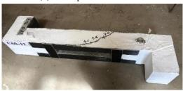
(c) Crack pattern for C60x6 (d) Crack pattern for C60x12 Fig. 12: Crack pattern for Group 5
