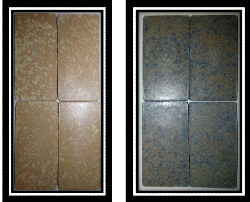
مجموعة صور رقم (10) توضح تأثيرات جمالية وتصميمية على سطح البلاط من تنوع الأحجام الحبيبية للتركيبات الملونة
