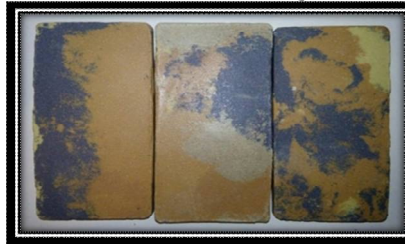
صورة رقم (7) توضح تأثيرات جمالية على سطح البلاطة من المسحوق الملون بالدمج بين تركيبات ملونة (3,4,6) ولون الجسم الأصلي .
