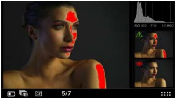
شكل (١٣) يظهر اللون الأحمر على شاشة الكاميرا الرقمية PHASEONE XF للتحذير من فقد التفاصيل في مناطق الإضاءة العالية من الصورة المجموعتين.
