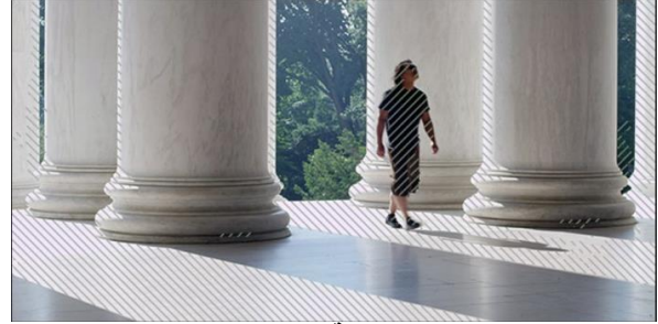
شكل الصورة عند تفعيل خاصية خطوط التظليل بكلا مجموعتيها - Dual Zebra Indicators
