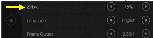
شكل (١٠) شاشة بيانات الكاميرات السينمائية Blackmagic تتيح اختيار قيمة النصوص التي تظهر عندها خطوط التظليل.
