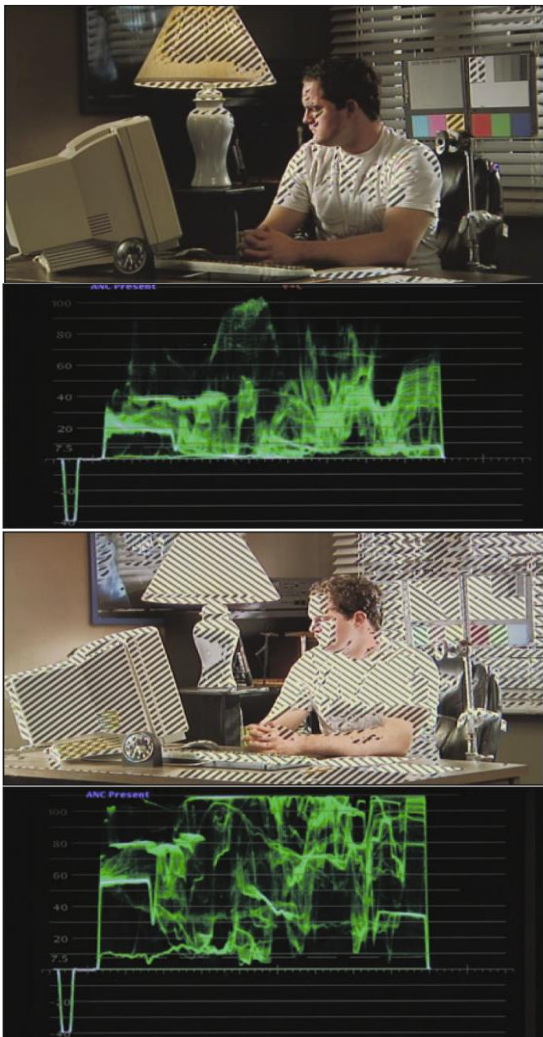
شكل (١١) مجموعتي خطوط التظليل في كاميرا Sony إحداهما تغطي المناطق ذات درجة النصوص ٧٠٪ والأخرى تميل بالزاوية العكسية وتغطي المناطق ذات درجة النصوص ١٠٠٪. ومقارنتهما بالمخطط الموجي في حالتي التعريض الصحيح في الصورة العليا والتعريض الزائد في الصورة السفلى.
