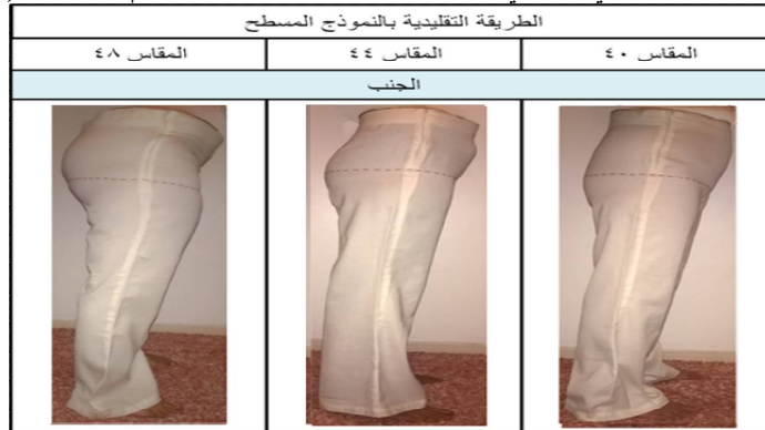
الشكل (6) نموذج البنطلون الأساسي النسائي مضاف إليها مقدار الراحة من الجنب للمقاسات (40 - 44 - 48) .
