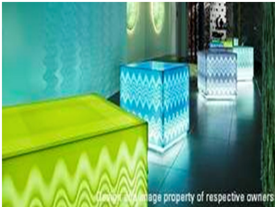
صورة رقم (2) توضح نفاذية الضوء من الكوربان مع إمكانية الرسم والطباعة عليه أيضاً
