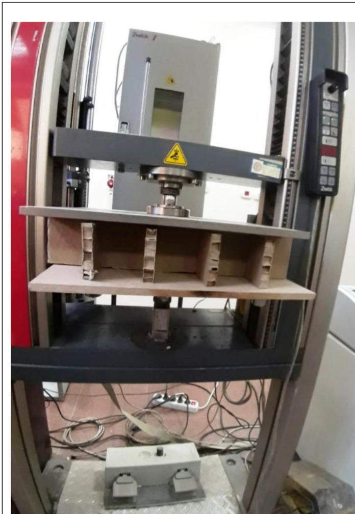
شكل (١٠) يبين العينة أثناء اختبار مقاومة الإنضغاط في الوضع الرأسي
