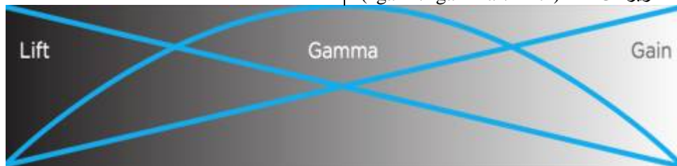
الشكل (٢٧) يعرض الرسم العلاقة بين ضوابط ( gain / gamma / lift ) خلال نطاق سطوع الصورة الذي يتحكمون فيه. اللون الأسود.
