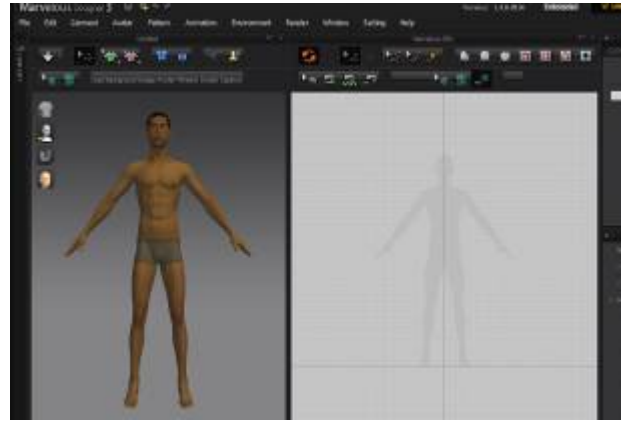
صورة رقم (17) توضح ضبط مقاييس ال Avatar • اختيار الاداه (Create Rectangle) لرسم اجزاء الجلباب فى المساحة المخصصة لذلك ويطلق عليها (Pattern Window) كما موضح فى صورة رقم (18)
