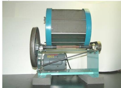
الشكل رقم (3) البرميل القلاب على الموتور المروحة.
