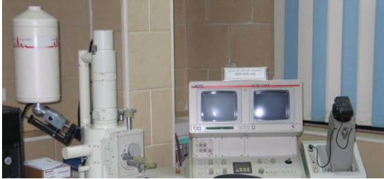
شكل (4) شكل (4) جهاز ( جهاز الميكروسكوب الإلكتروني الماسح ووحدة عد الإشعاع السيني المميز) [7] ( Scanning Electron Microscope Energy Dispersive X-Ray)
