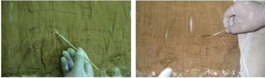
شكل (٨-أ) اختبار ثبات الحبر تجاه الماء المقطر شكل (٨-ب) تثبيت الحبر بإستعمال مادة البارالويد B72.
