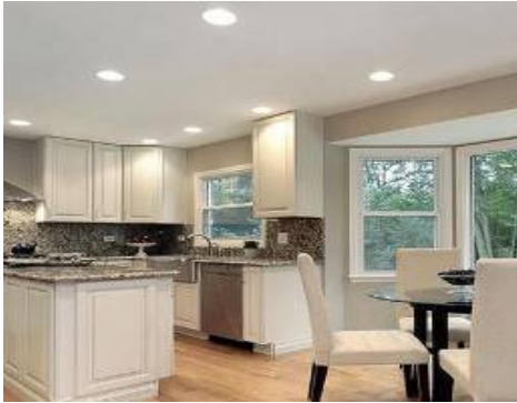
شكل (15) تصلح الإضاءة الغائرة Recessed Lighting للإضاءة المحيطة في المطبخ.
