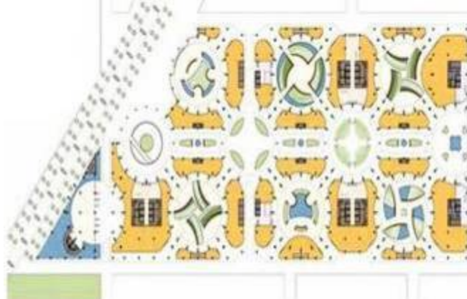
شكل (18) تحليل شكل المسقط الأفقي بالدور الأرضي حيث تمثل الفراغات البرتقالية الحيزات التجارية لمبنى مقر إدارة مصدر للطاقة بينما الفراغات الزرقاء تمثل العناصر المائية.
