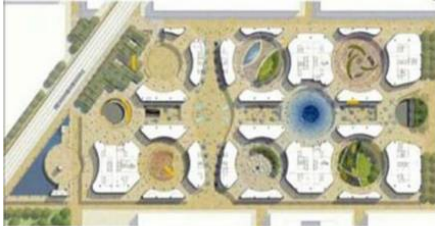
شكل (20) قطاع أفقي في مبنى إدارة مصدر الطاقة حيث تمثل الحيزات البيضاء شكل الحيزات الإدارية وفواصلها الداخلية التي تميزت بأشكالها الغير منتظمة.
