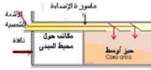
(ب) رسومات توضيحية لفكرة استغلال الإضاءة الطبيعية من خلال مواسير الإضاءة لإتارة الفراغ الأوسط بمبنى محاط بمكاتب حول محيط المبنى للاستفادة منها.
