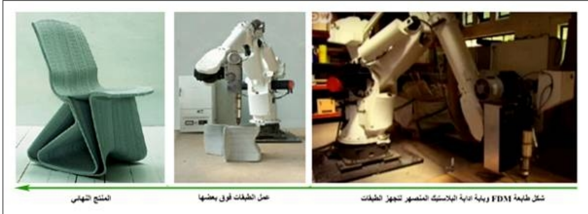
شكل (١٥): مراحل إنتاج كرسي باستخدام تكنولوجيا FDM، (٣٥)
