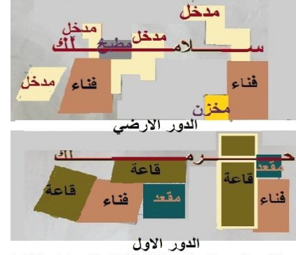
شكل (١٣) قطاع أفقى بالدور الارضى والاول لمنزل الكريديلة وامنة بنت سالم يتضح بها منطقة السلامك والحرملك والمدخل المنكسر
