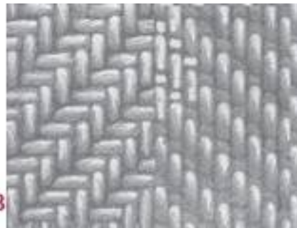
شكل رقم (2) توضح التأثيرات النسجية ( A أطالس سداء ولحمة متجاورين بالمظهر السطحي )
