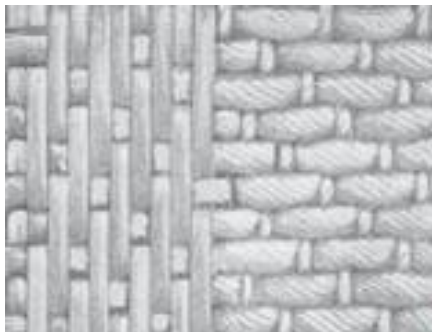
شكل رقم (2) توضح التأثيرات النسجية ( A أطالس سداء ولحمة متجاورين بالمظهر السطحي )
