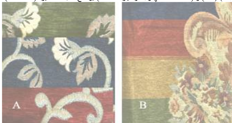
شكل رقم (18) (A) يوضح مرباجات تشغيل قلابات متغيرة لشانيليا الأرضية (مساحات) قماش منفذ (B) يوضح قلابات متغيرة لشانيليا الأرضية (مساحات) قماش منفذ
