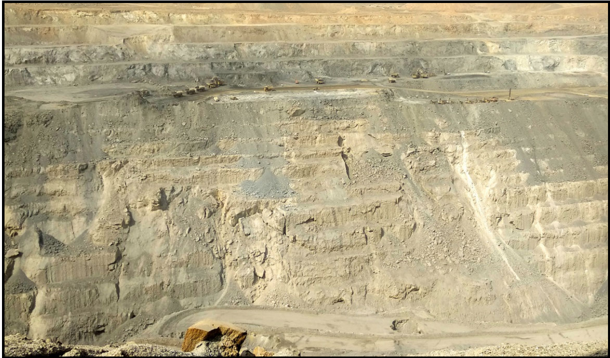
صورة (٥) ركامات الهشيم وحركة المواد بالمدرجات الاصطناعية في حفرة التعدين السطحي (تاريخ التصوير ٧ فبراير ٢٠١٩)
