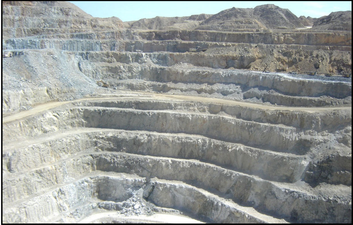
صورة (٤) عدد من المدرجات الاصطناعية في حفرة التعدين السطحي (تاريخ التصوير ٣ مارس ٢٠١٥)
