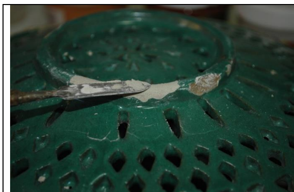
صورة (38) تطبيق الجبس باستخدام Spatula لاستكمال الأجزاء المفقودة القطعة من الفخارية المزججة (353)
