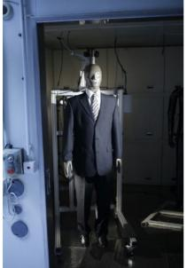
Figure 8. Sherlock thermal manikin **5.6. Sherlock thermal manikin**
