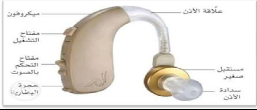
الشكل (٠٣) مكونات سماعة الأذن (ركزة، ٢٠١٤: ٧٣)
