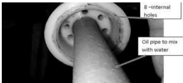
Fig. 4. Turbulence suppression section
