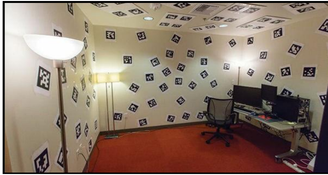
الشكل (16) مثال على نظام التتبع من الداخل إلى الخارج حيث يستند إلى عدة علامات مع أنماط فريدة معروفة وضعت استراتيجيا على جدران وسقف الغرفة.
