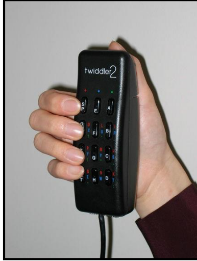
الشكل (2) لوحة مفاتيح chord keyboard ذات 12 مفتاح
