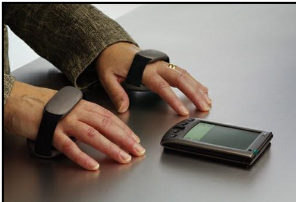
الشكل (3) نموذج للوحة المفاتيح الافتراضية Senseboard virtual keyboard prototype
