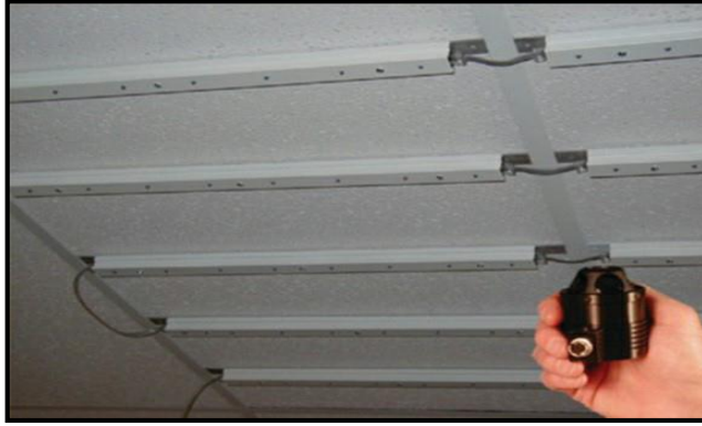
الشكل (15) نظام تتبع HiBall حيث يتم تركيب منارات ليد على السقف، وتقع أجهزة استشعار الكاميرا في يد الكائن المتحرك
