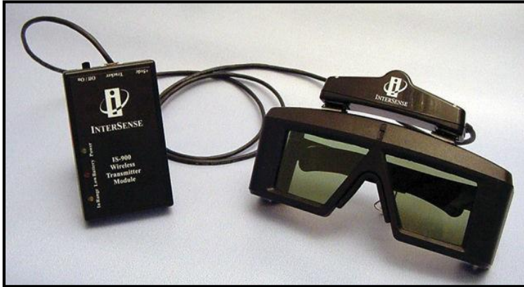
الشكل (21) جهاز تعقب هجين لاسلكي بالقصور الذاتي / الموجات فوق الصوتية
