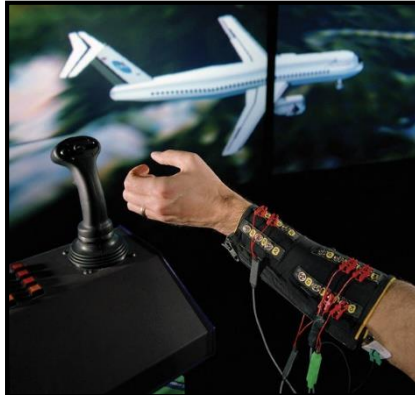
الشكل (26) مثال على الجهاز الذي يتتبع حركات الإصبع والإيماءات باستخدام أجهزة الاستشعار EMG للكشف عن نشاط العضلات في الساعد
