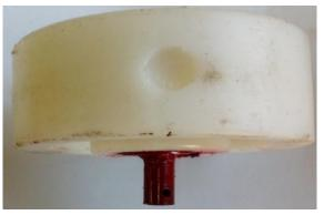
Fig. (5):Seed Metering Device
