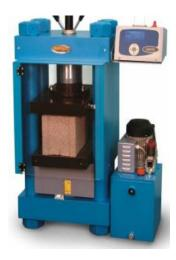
Fig. (5). a: Compressive test machine.
