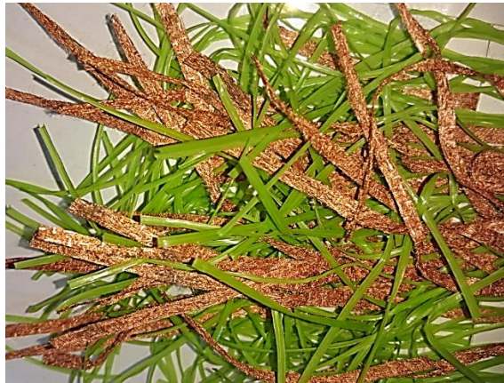
Fig. 3 PE turf blended by Cu textile on PP substrate.
