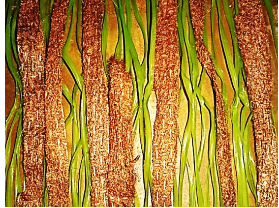
Fig. 2 PE turf blended by Cu textile on Cu substrate.
