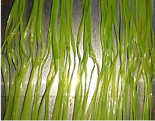
Fig. 1 PE turf on steel substrate.
