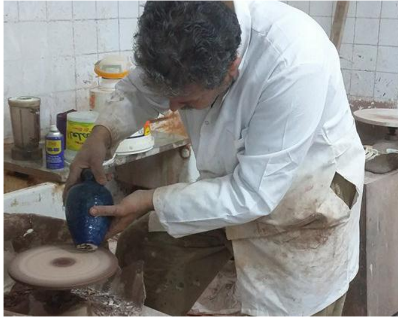
صورة توضح الباحث أثناء تهذيب قاعدة الشكل من الطلاءات الزائدة المتجمعة حولها
