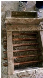
- Fill box test
