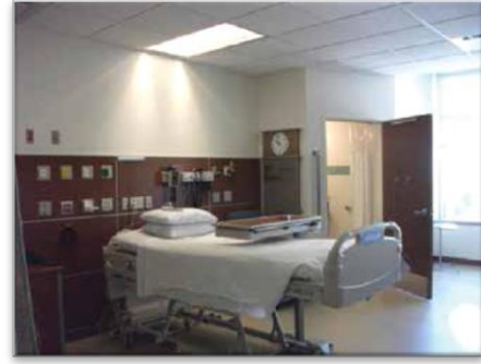
صورة (13) استخدام أبواب للحمام من نوع تظل مفتوحة طوال الوقت [1]
