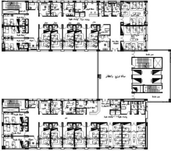
صورة (19) المسقط الأفقي لدور الإقامة بمركز علاج الأورام (الدور العاشر) [*] يحتوي الدور علي وحدتين إقامة بكل وحدة 25 سرير منهم 3 غرف فردية، 5 غرف زوجية، 2 عنبر بكل عنبر 6 أسرة، ولكن بعد الدراسة الميدانية للمركز لم يتم تطابق الرسومات بالواقع وتم فرش 8، 9 أسرة بالعنبر، وفرش 3 أسرة بالغرفة الفردية والزوجية. لا يوجد سوي محطة ترميز واحدة بكل وحدة إقامة.
